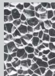
Abb.2: geschlossen-zelliges Material (Zellgummi)
